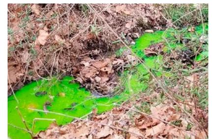
*Izquierda: Prueba de tinte revela contaminación de los sistemas sépticos con fugas. Clean Water Action promovió legislación en Maryland para aumentar la detección y aplicación para reparar los sistemas con fallas, y creó apoyo en Michigan para normas estatales (ahora el único estado que carece de ellas).*
